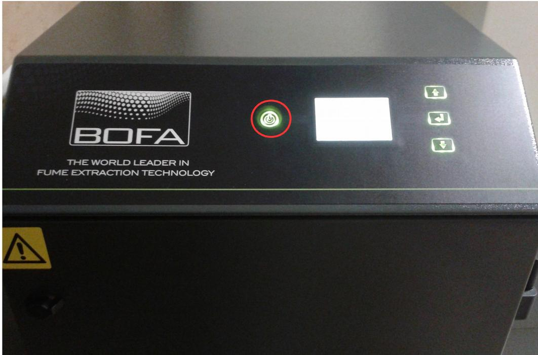
En fonction des matériaux que l'on va découper, il sera utile de faire varier le débit d'extraction des fumées et gaz. Par exemple, la découpe de médium génère beaucoup de fumée, le débit maximal (380 m<sup>3</sup>/h) sera utile.
