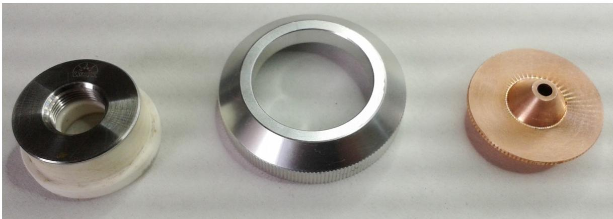
Buse démontée et nettoyée, prête à être remontée
