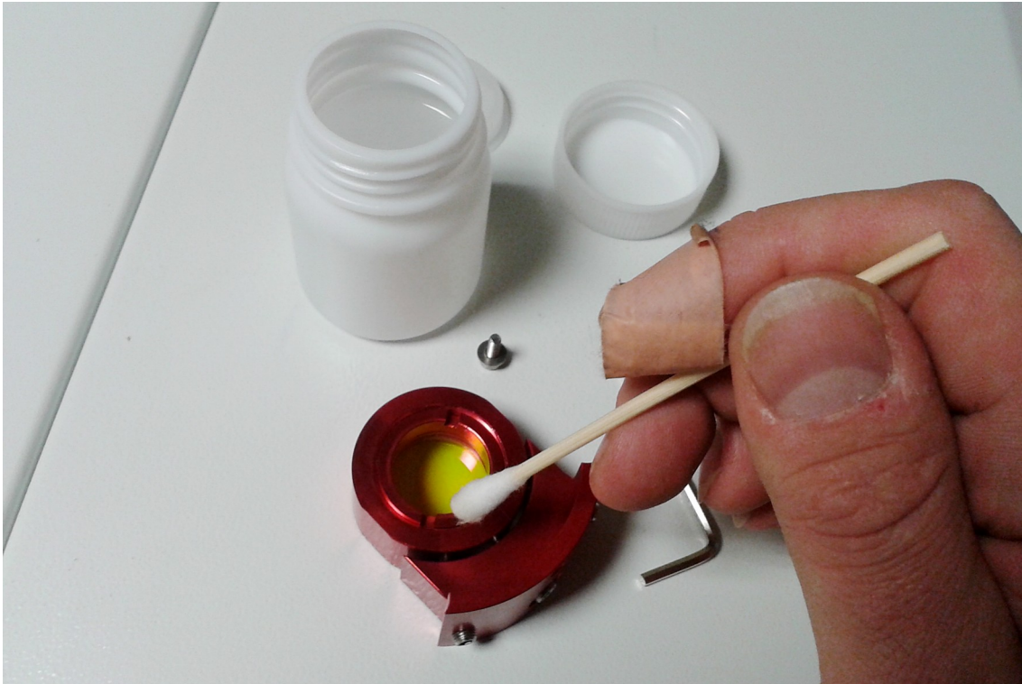
Nettoyage de la lentille sur ses 2 faces à l'aide d'un coton tige et l'alcool ménager.
